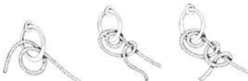
CFCD 105 Seamanship Rigging and Procedure Manual Figure 10-1-6 Tour mort et deux demi-clés
