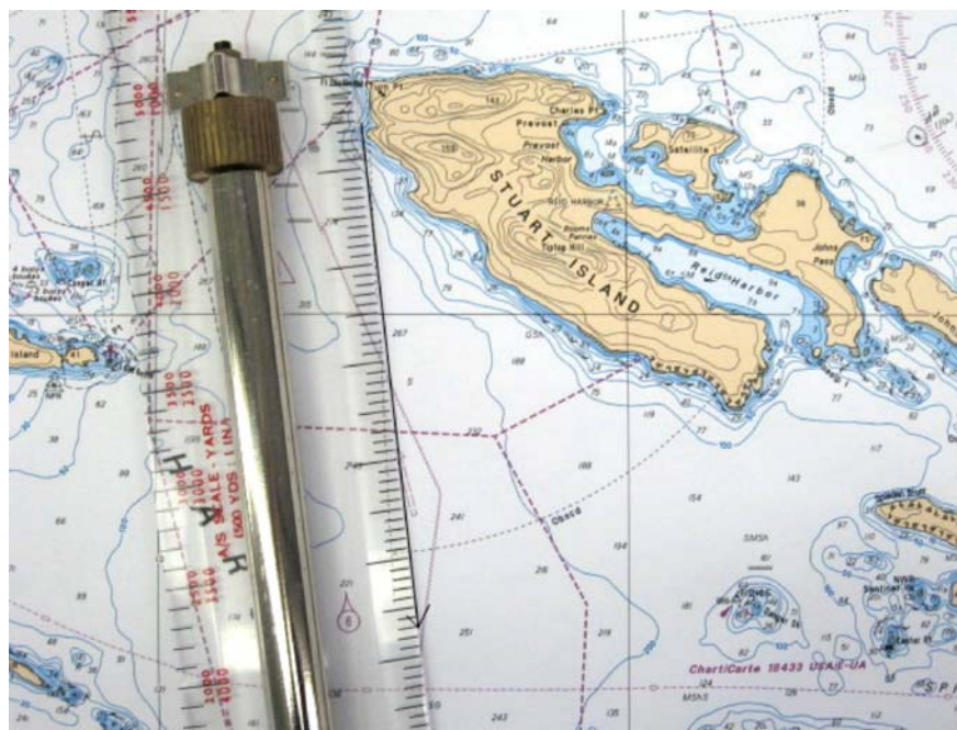
Figure 3 Ligne de position – Étapes 3 et 4
